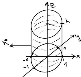
$$\vec{r}(\varphi, z) = (\cos\varphi, \sin\varphi, z) \quad \leftarrow \text{voljne koordinate} \\ \varphi \in [0, 2\pi], z \in [0, h]$$
